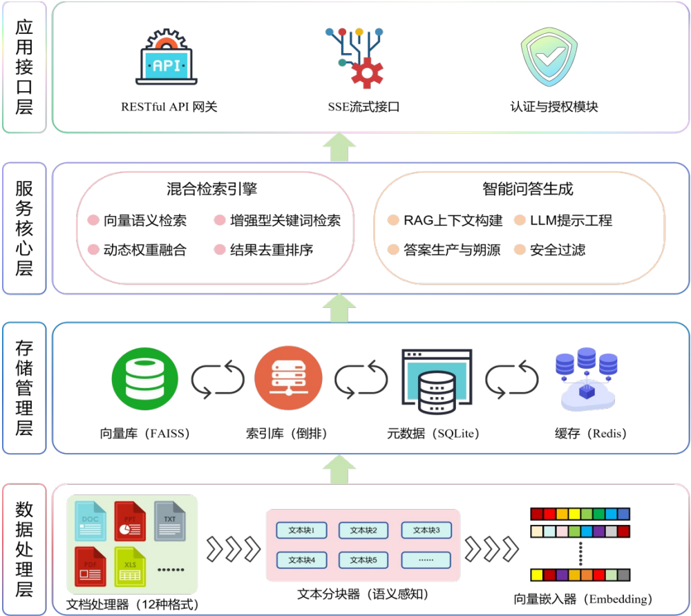
图 1 系统整体架构
